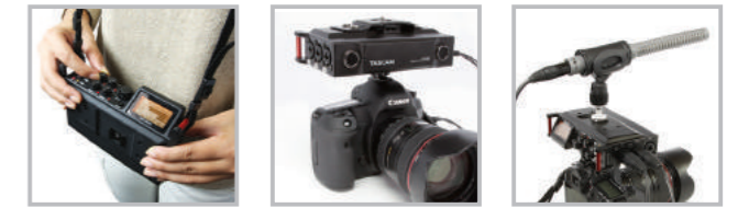
ストラップでの吊り下げ例 カメラ上部 取り付け例 ガンマイク取り付け例 本写真は、他社製カメラ、三脚などの組み合わせ一例です。カメラ本体、レンズ、マイク、マイクケーブル、三脚、ストラップなどは付属しません。DR-70Dをカメラの上に取り付けるには、市販のシューマウントアダプター、または別売のAK-DR70Cが必要です。
