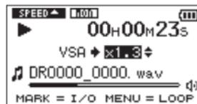
La función VSA puede modificar la velocidad de reproducción en el rango entre 0.5 (50%) y 1.5 (150%) veces (en incrementos de 0.1) la velocidad de reproducción normal.
