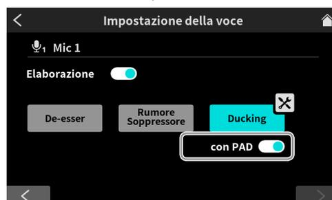
Attivare l'interruttore "con PAD" per abilitare contemporaneamente anche il ducking dei suoni del pad (predefinito: SPENTO).
