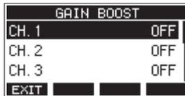
3. Tournez la molette MULTI JOG pour sélectionner le canal dont le réglage GAIN BOOST doit être changé.
