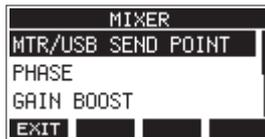
2. Sélectionnez GAIN BOOST (renforcement du gain) en écran MIXER, et ouvrez l'écran GAIN BOOST.
