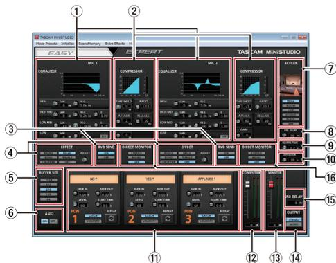
Se il trattamento audio non riesce a tenere il passo, per esempio, a causa di altre operazioni di sistema, potrebbero verificarsi clic e rumori e il segnale audio potrebbe anche interrompersi. L'aumento delle dimensioni del buffer stabilizzerà il funzionamento e sopprimerà gli effetti negativi sui segnali audio, ma aumenterà il ritardo nei segnali audio inviati al computer. È possibile utilizzare il cursore sul pannello per regolare la dimensione del buffer, in base alle condizioni d'uso.
