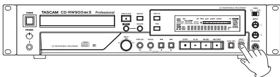
ボタンを押すたびに、3種類の録音ソースが切り換わります。現在選ばれている録音ソースは、以下のインジケーターの状態で確認できます。
