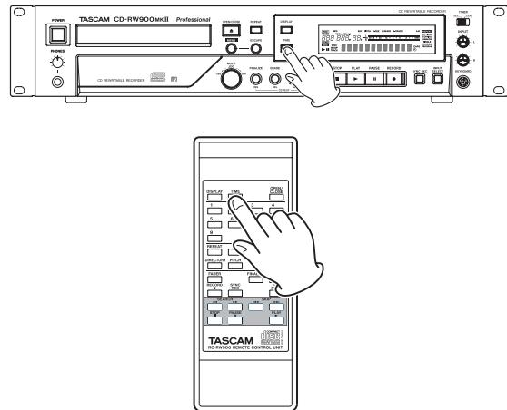
TIMEボタンを押すたびに、4種類の時間表示が切り換わります。現在選ばれている表示方法は、以下のインジケーターの状態で確認できます。
