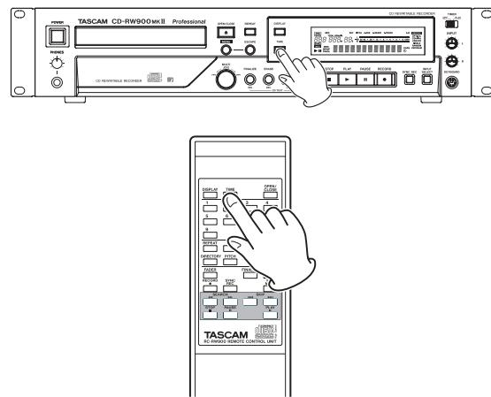
ボタンを押すたびに、4種類の時間表示が切り換わります。現在選ばれている表示方法は、以下のインジケーターの状態で確認できます。
